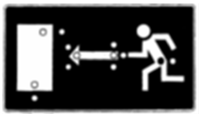
Фигура 6. Схема на измерване на яркостите и таблица с резултатите
