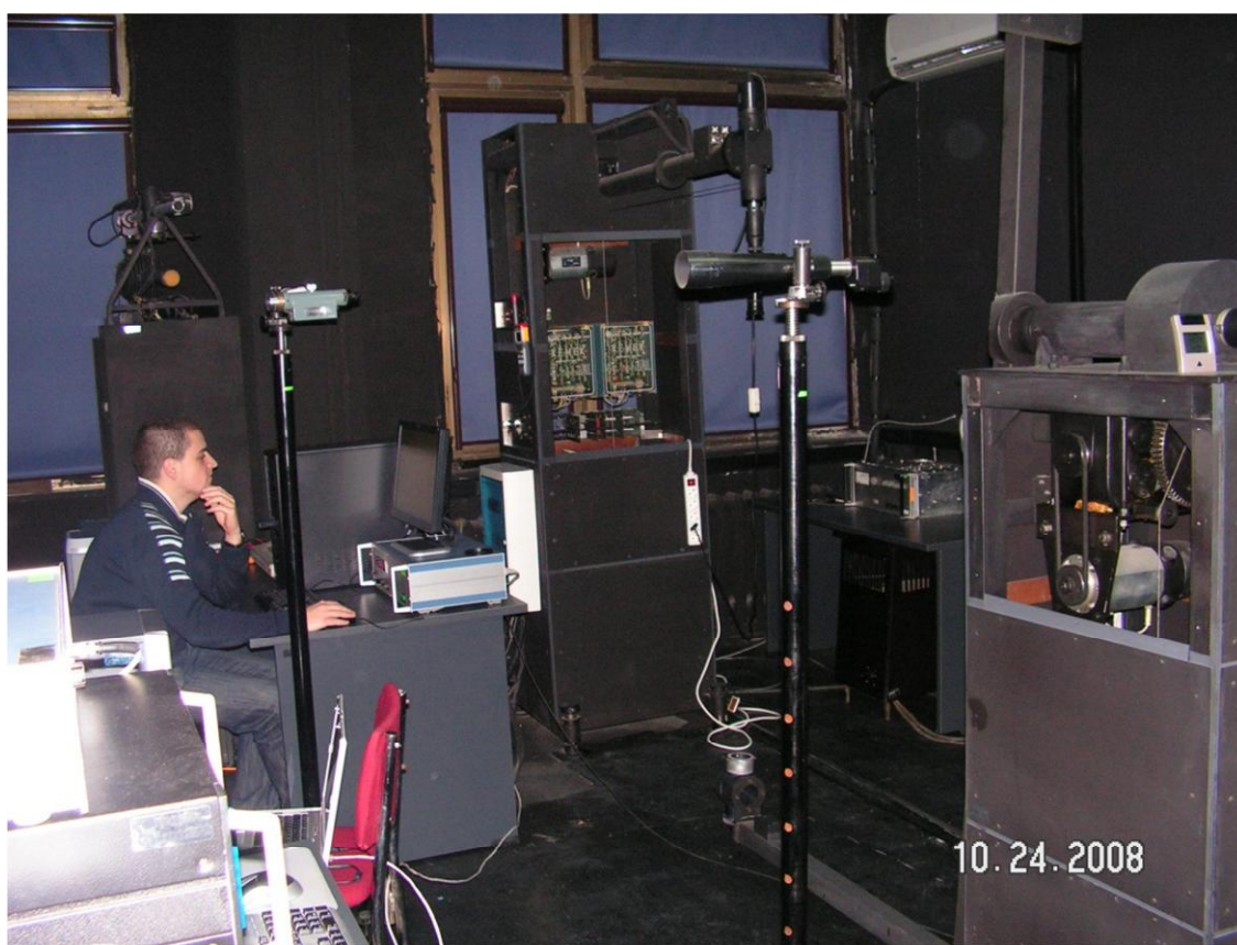
Фиг. 9. Гониофотометър за измерване на светлинен поток на НЦМ-България
