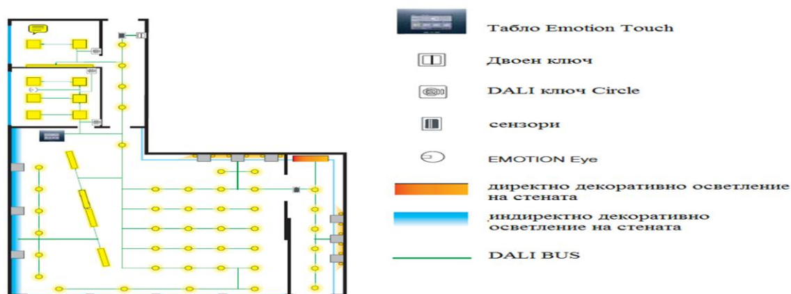
Фиг. 3. Примерна структура на системата Luxmate Emotion на фирмата Zumtobel за биодинамично осветление.
