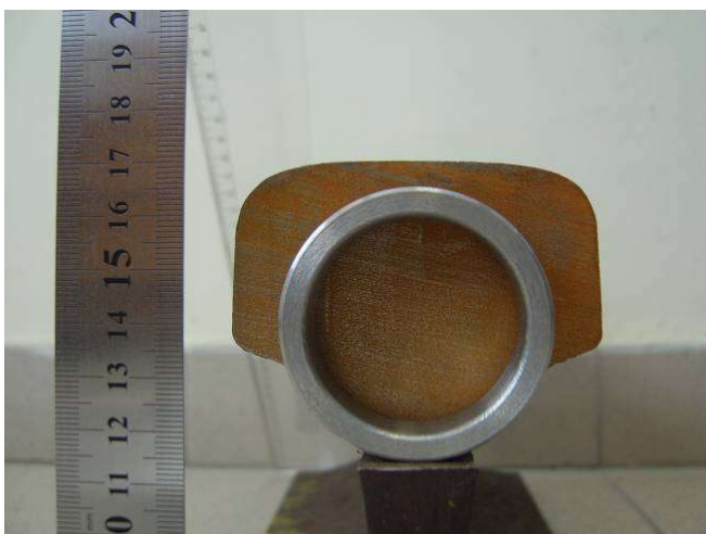
Фиг.3. Релса 60E1 и изрязаната от нея проба вторична намотка
