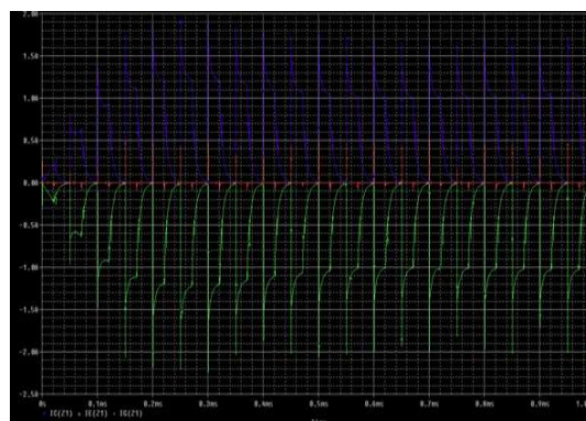
Фиг.8. Токовете през транзистора Z1(ZbreakN) , IC(Z1) ; IE(Z1) ; IG(Z1) във функция от времето
