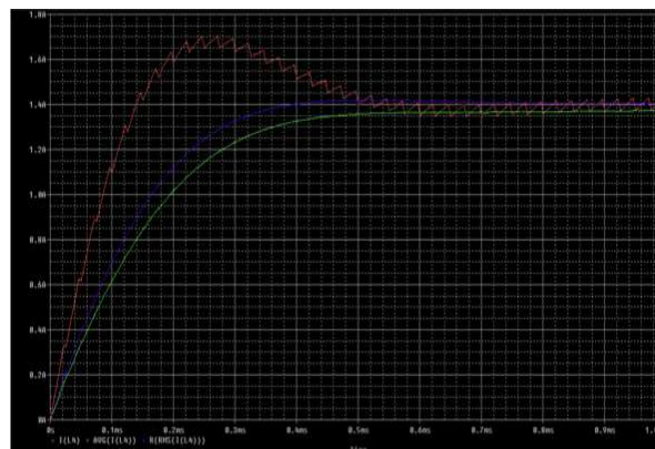
Фиг.5. Токът през дросела I(L4) , като текуща средна стойност (AVG), и текуща ефективна стойност (RMS) във времето.
