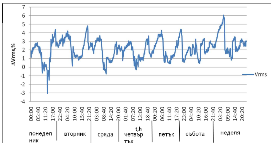
Фиг. 6. График на отклонение на напрежението на фаза L1 – измерено на общите шини ниско напрежение
