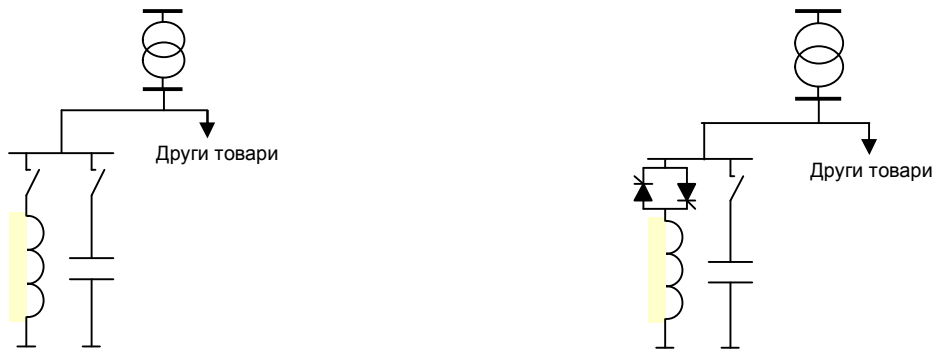
Фиг. 3. Варианти за компенсирание с превключваеми индуктор и кондензатор, както и с TCR
