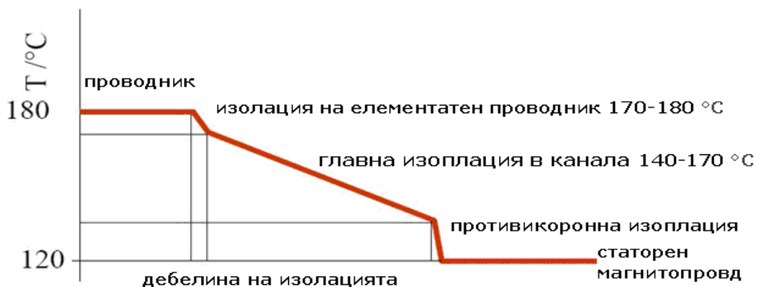
Фиг.4. Температурни падове в елементите на VPI изолационна система
