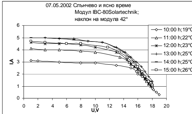
Фигура 7. V-A характеристика на панел при постоянен ъгъл на наклон за различно време от деня
