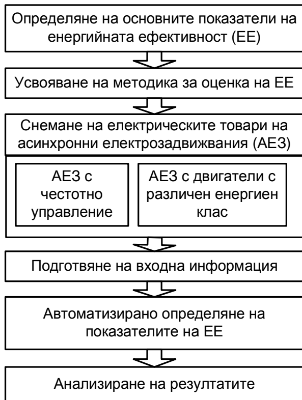
Фиг.1. Блокова схема на етапите на методика за обучение в областта на енергийната ефективност на асинхронни електрозадвижвания
