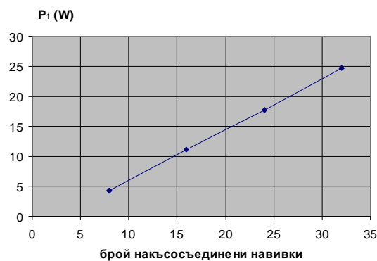
Фиг.8. Активна мощност в първичната намотка на крайно ядро в зависимост от броя навивки в накъсосъединения контур
