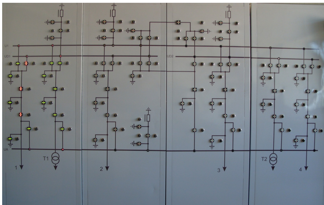
Фигура 6: Командни табла към стенд - симулатор на оперативни прекъсвания
