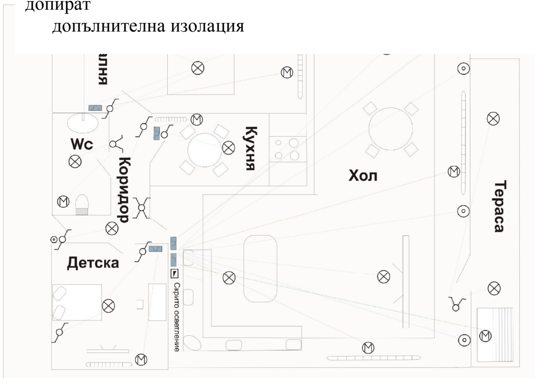
Фиг.12. Приложение на интелигентна електрическа инсталация в жилище
